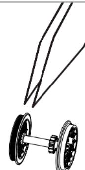
Si utilisation fréquente, huilez régulièrement avec une goutte d'huile fine pour machine à coudre. Nous vous conseillons un rodage complet de 25 min dans chaque sens pour un roulement optimal. Il est conseillé de nettoyer régulièrement vos rails pour un bon fonctionnement.
